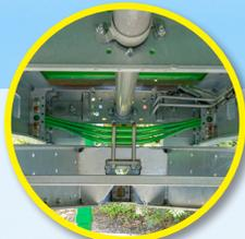
Lanza en «V» ajustable con suspensión con láminas parabólicas
