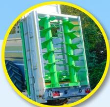
Cilindros verticales de gran diámetro con palas replegables y ganchos de HARDOX 450
