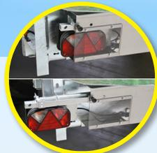
Luces de señalización encastradas y escamotables, protegidas por un plexiglás en posición cerrada
